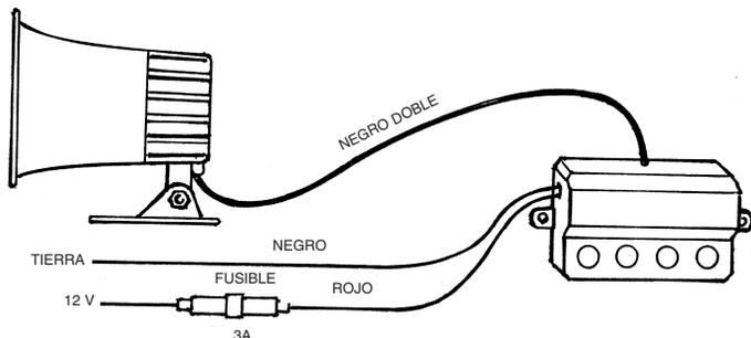
6. **CABLE NEGRO SENCILLO** Va conectado a tierra. Asegure el cable bajo un tornillo en el área del tablero, asegurese que la superficie de METAL alrededor del tornillo este limpia de óxido y pintura para hacer una buena conexión eléctrica.
