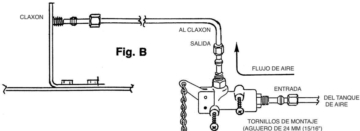
6. Usando la manguera de 6,35 mm (1/4") plástica proveída, corte al tamaño para conectar la válvula de acción manual. Coloque la tuerca de bronce y adaptador de compresión en la manguera. Presione la manguera hacia a la conexión hembra de la válvula de acción manual y apriete la tuerca de bronce hacia el **PRECAUCIÓN:** No se exceda en apretar la tuerca de bronce.
