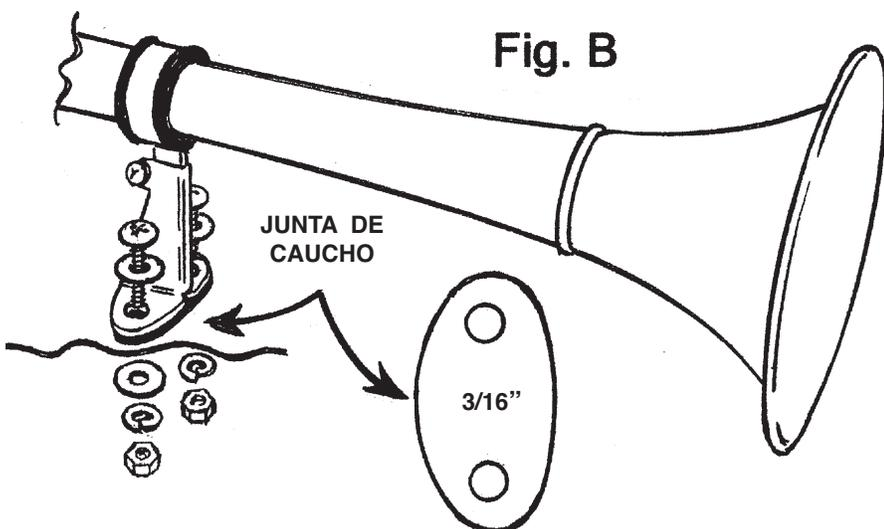
3. Asegure el claxon usando los artículos de ferretería proporcionados. Apriete los tornillos de manera uniforme para prevenir daños al claxon. (Vea la Fig. A.)
