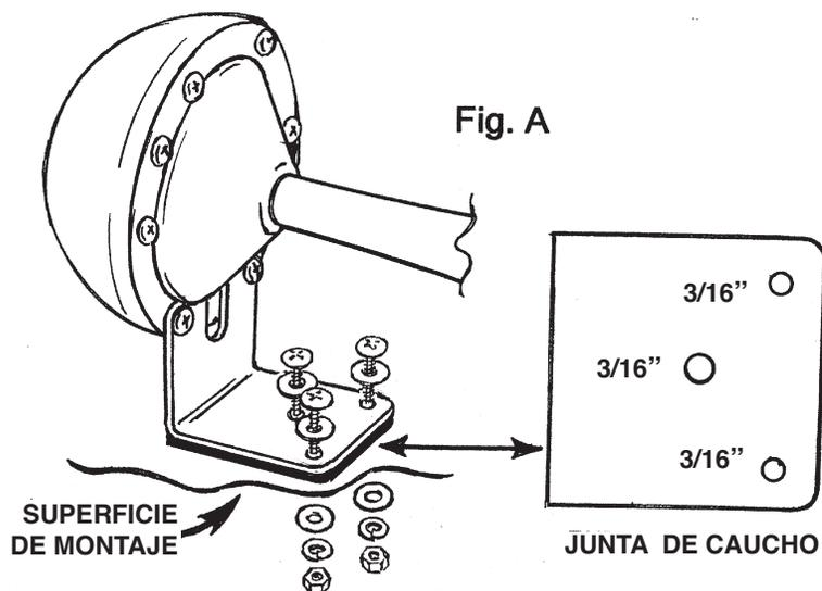
montaje y taladre al tamaño. (Vea Fig. C) **IMPORTANTE:** Asegúrese de que el agujero esté libre de bordes mal acabados que puedan cortar el cable del claxon. Para montaje en el techo, para prevenir fugas de agua, se recomienda que se coloque silicona o un sellador a prueba de agua en el cable en el punto de entrada del techo.
