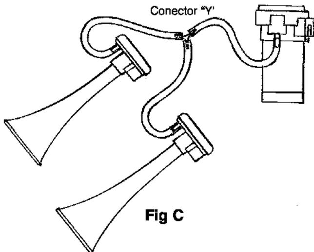
5. Corte el tubo plástico para el aire, conecte el claxon tipo trompeta y el conector "Y" tal como se muestra en la figura C. No permita ningún dobléz ni torcedura en el tubo, ya que éso podría restringir el flujo del aire y alterar el sonido del claxon.
